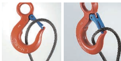
ワイヤロープのヨリが発生し、回転した状態
