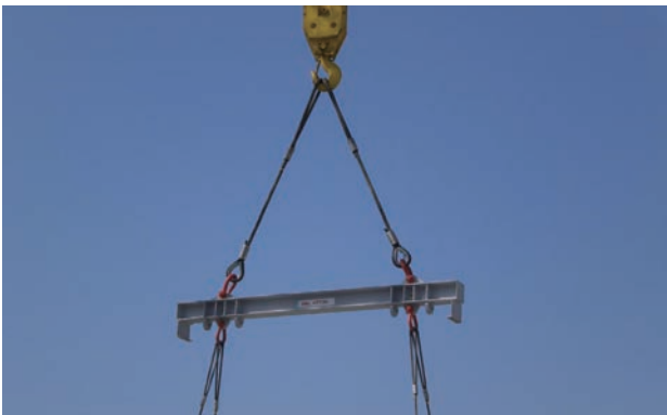
吊り天秤・シャックル使用例
